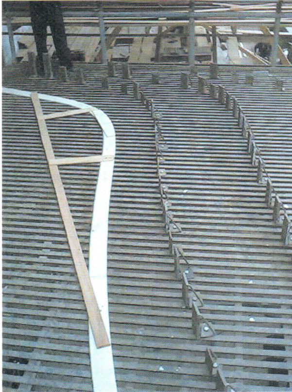
Resim 1 Tezgahın şablona göre hazırlanması
