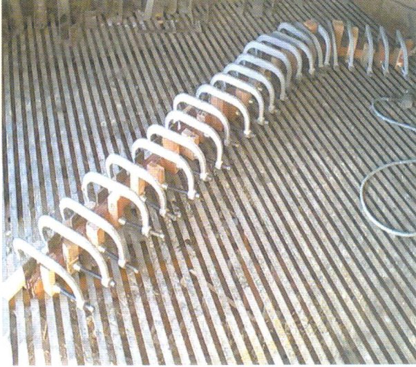
Resim 2 Pnömatik alet ile sıkılmış posta
